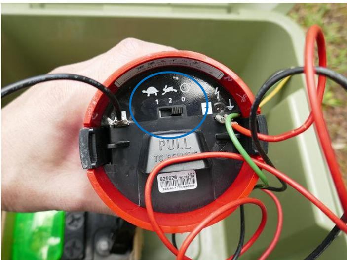
電源の底面に電源スイッチがあり、0側(一番右)にすると、通電がoffになります(バチバチと音がしなくなります)。
