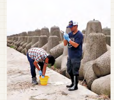
奈良県から大阪府へと流れる大和川での調査。採水した水をその場でろ過する
