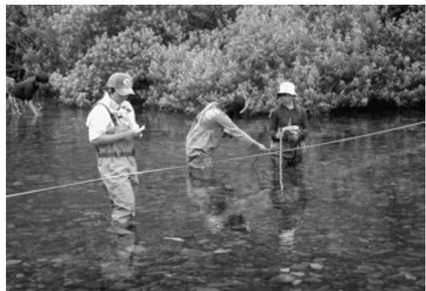
支流の小川での流速分布測定
