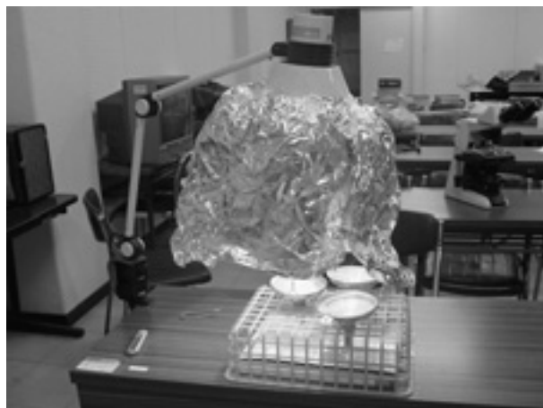
土壌性節足動物採集用の手作りの簡易ツルグレン装置
