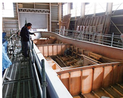
写真3：新「緑洋丸」の外殻補強作業
