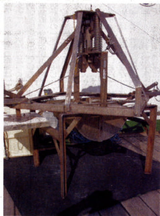
ペンントスを定量採集できるスミスマッキンタイヤ型採泥器
