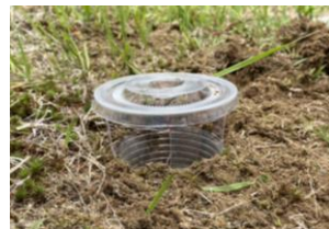
図1 ピットフォールトラップ 地面にプラスチックカップを埋め 落下した昆虫を採集
