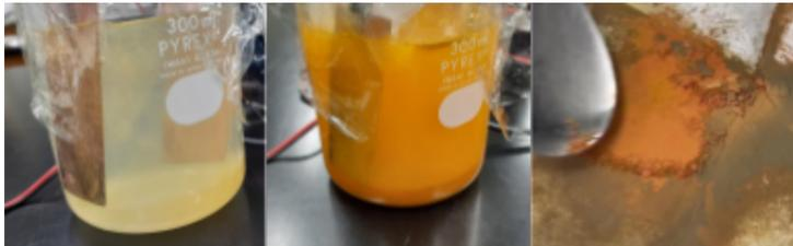
図2. 実験1「銅板を用いた塩化ナトリウム水溶液の電気分解」
